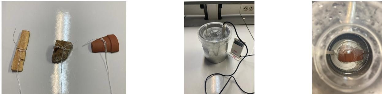
Figure 6: Expérience pour trouver la capacité massique de la terre cuite
