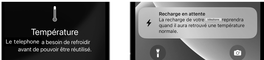
Figure 1 Messages d'alerte en cas d'utilisation d'un téléphone à haute et basse température
