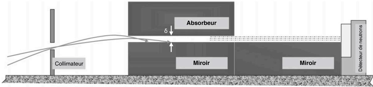
31. On suppose pour simplifier que les neutrons incidents sont uniformément répartis suivant  $v_z$  et suivant  $z$ , sur toute la hauteur du couple absorbeur-miroir. Si on réalise des expériences avec différentes valeurs de  $\delta$ , montrer que le nombre de neutrons vus par le détecteur par unité de temps est proportionnel à  $\delta^\alpha$ , où  $\alpha$  est une constante qu'on déterminera.
